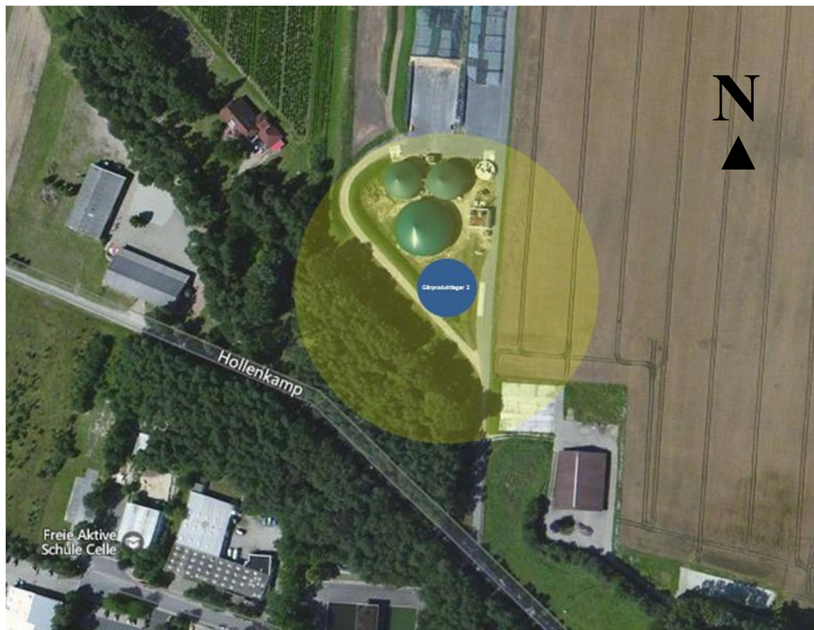
Abbildung 7: Ausbreitung der explosionsfähigen Atmosphäre ausgehend vom Gärproduktlager 2 – schemenhaft Windrichtungsunabhängig /Quelle: Bing Karten 2015/
